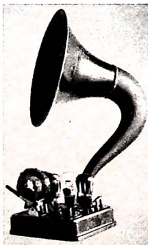
„T 10“ ein Empfänger von Telefunken aus dem Jahre 1926 für Batteriebetrieb
